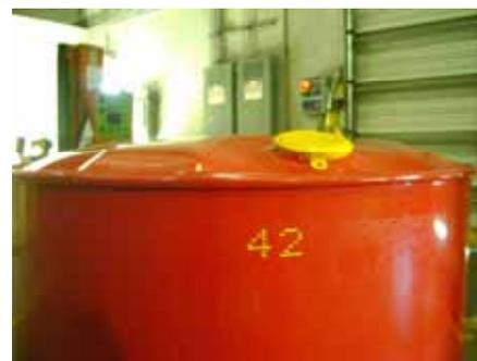
訓練を受けた人が適切な個人用防護具を装備して、圧力を逃すための緊急対応を行って下さい。特別に開発された鋭い先端を持った槍状の器具を使って、上部の巻き締め部の下に急いで小さな穴を開けて下さい。
