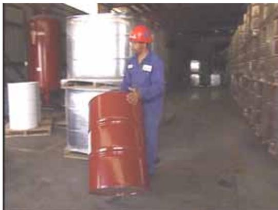
ドラムをタイヤや軟質ブロックフォームの上に落として荷卸するという行為は危険なのでしないで下さい。ドラムの巻き締め部にフォークリフトの爪を引っ掛けて持ち上げて移動することはしないで下さい。
